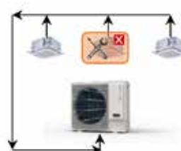
Холодоагент зберігається в ODU
