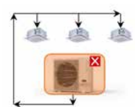
Холодоагент, що зберігається в IDU
